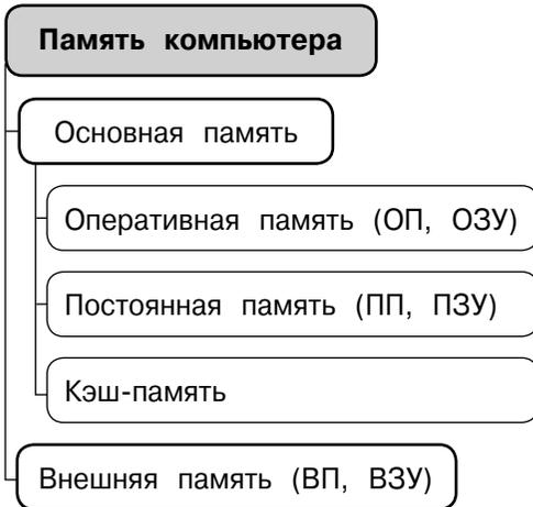
**Оперативная память (ОЗУ — оперативное запоминающее устройство)** представляет собой набор микросхем, предназначенных для временного хранения данных, когда компьютер включён. В этой памяти хранятся исполняемые программы и данные.
